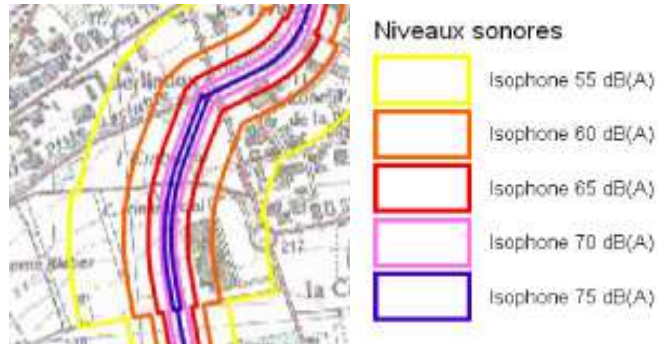
Carte A - Indicateur Lden représentation graphique des zones exposées au bruit de jour, à l'aide de courbes isophones en Lden allant de 55 dB(A) à 75 dB(A), par pas de 5 dB(A)
